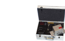
Měřicí systém pro měření dobohových časů a výpočet umístění bezpečnostních prvků dle normy ISO 13855
